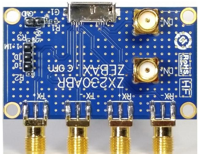
[ZX230ABR Type AB Receptacle USB Test Fixture S-Parameter](#)
